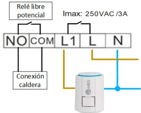
CABLEADO CON CAJA DE CONEXIONES A CALDERA
