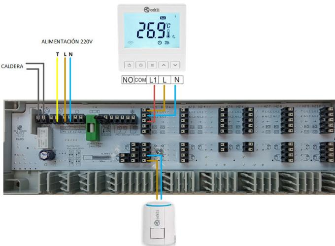
CABLEADO CON CAJA DE CONEXIONES A BOMBA
